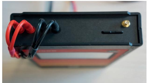
Figura 5. Conexión correcta E-1000.
