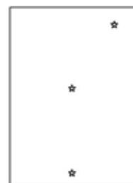
Figura 3.1. Posiciones para la colocación de los sensores de temperatura en un módulo fotovoltaico en base a la norma IEC 61853-1.
