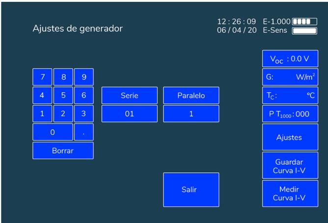
Figura 5.14. Submenu de ajustes de generador.
