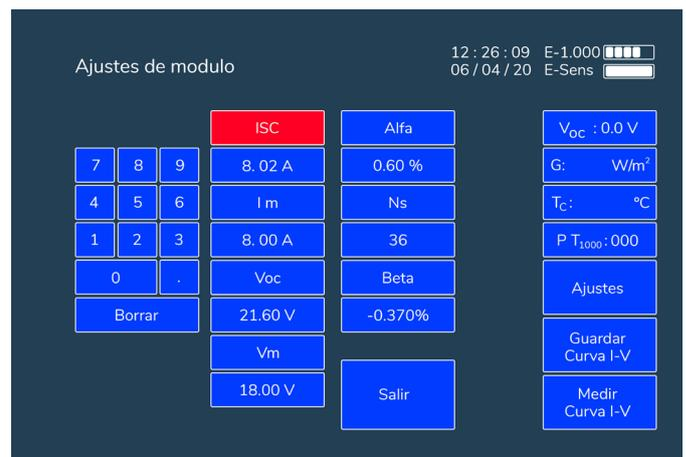
Figura 5.13. Ajustes de generador.
