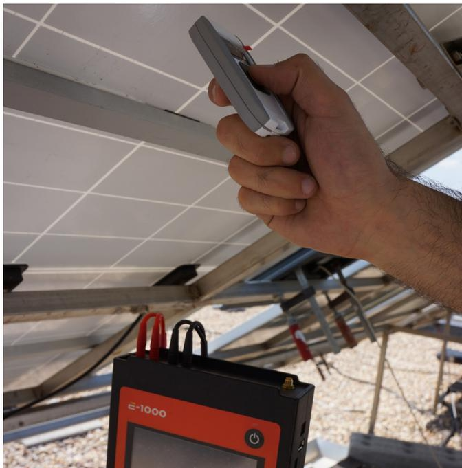
Figura 5.5. Medida de temperatura mediante E-Temp.
