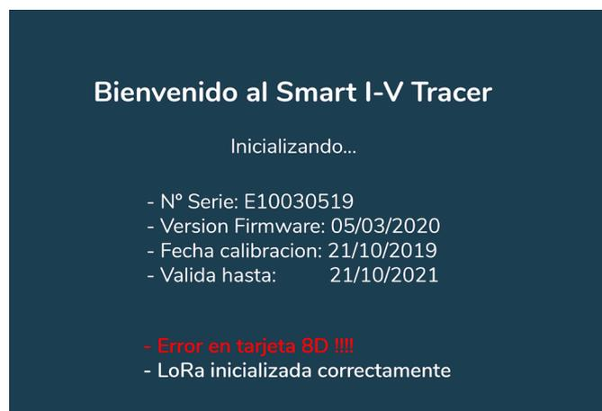
Figura 5.2. Pantalla de inicio con error en tarjeta.
