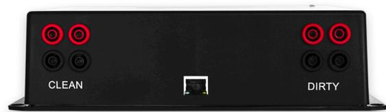
**Figura 3:** Periféricos frontales, que incluye: cuatro conectores hembra de tipo banana para el módulo limpio (clean) y otros cuatro para el módulo sucio (dirty) y un conector RJ-45 para la conexión Ethernet. Los conectores rojos son para el polo positivo y los conectores negros para el polo negativo.
