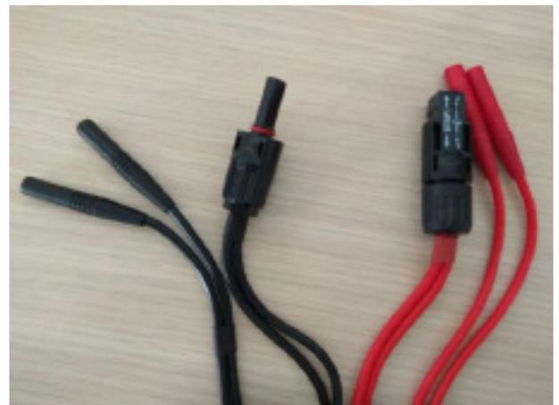
**Figura 6:** Ejemplo de un juego de cables (positivo y negativo) para la medida a 4-puntas. En un extremo, ambos cables se conectan al MC-4 y en el otro extremo cada cable se conecta a una banana macho aislada.
