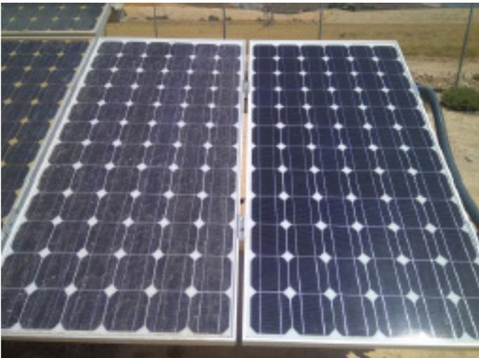
**Figura 4:** Ejemplo de dos módulos instalados, uno como referencia de módulo sucio y el otro como referencia de módulo limpio.
