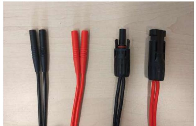
Figura 6: Ejemplo de un juego de cables (positivo y negativo) para la medida a 4-puntas. En un extremo, ambos cables se conectan al MC-4 y en el otro extremo cada cable se conecta a una banana macho aislada.
