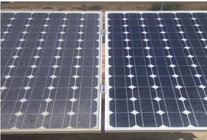
Figura 4: Ejemplo de dos módulos instalados, uno como referencia de módulo sucio y el otro como referencia de módulo limpio.
